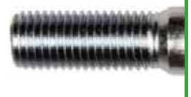
GOUJON EN BON ÉTAT
