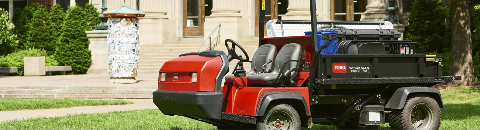
Le Toro Workman HDX-D est l'utilitaire le plus robuste du marché, avec sa capacité de charge exceptionnelle il est l'utilitaire idéal sur les gros chantiers. Son essieu en forme de «I» offre une résistance sept fois supérieure à celle des essieux tubulaires traditionnels, son plateau peut transporter jusqu'à 1 520 kg et son moteur à injection électronique assure une utilisation optimale du carburant, faisant de lui le leader incontesté parmi les véhicules utilitaires sur le marché actuel.
