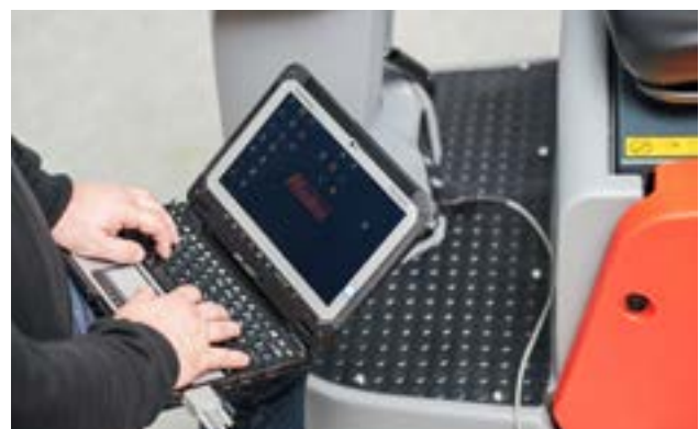
Accès facile à l'interface de diagnostic qui permet à la fois une maintenance simplifiée et la modification des paramètres.
