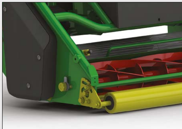
Contrôle de la hauteur de coupe facile à régler
