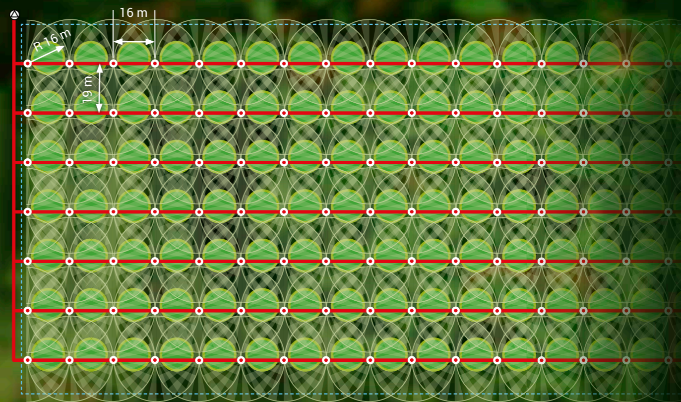
Exemple de schéma de configuration montrant des arroseurs plein cercle ZB 22 dans des vergers (détail)
